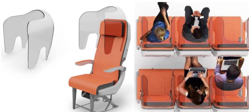
( الشكل 7 ) يوضح المقترح لتفعيل الإجراءات الوقائية لمقاعد الطائرة على الجانبين توضح الشركة. في هذه الأثناء ، يتم توجيه الركاب الجالسين على المقاعد الجانبية في اتجاه الرحلة. كل مقعد محاط من ثلاث جهات بدرع يمنع التنفس من المرور مباشرة إلى المقاعد المجاورة. يسمح الترتيب بفصل جميع الركاب الثلاثة على التوالي عن بعضهم البعض ، وكذلك عن المضيفات الذين يستخدمون الممر. مصنوع من مواد آمنة وسهلة التنظيف ، متوفر بمادة غير شفافة أو بدرجات مختلفة من الشفافية.
